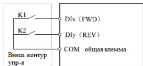
2: режим управления трехлинейного типа: в данном режиме DIn включающая клемма, направление регулируют Dix, Dly.
