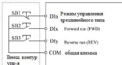
средством импульса DIn или Dly, поднимающегося вдоль двигателя, чтобы реализовать управление движением вперед или назад
