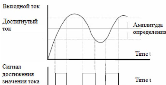
Схема функции достигнутого тока и достигнутой частоты
