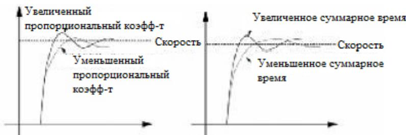
Рисунок 8. Параметры контура скорости Р1
